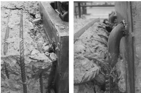
Bild 5-34: Verformung in den Kopfbolzen im Versuch R4-1-3 mit höherfesten Kopfbolzen (links) und im Versuch R4-2-3 mit normalfesten Kopfbolzen (rechts)
