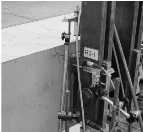
Bild 5-42: Rissbildung im Versuch R2-1 bei 80 % der Höchstlast
