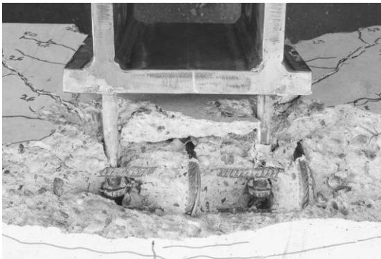
Bild 5-14: Betonausbruch auf der lastabgewandten Seite im Versuch B1-1
