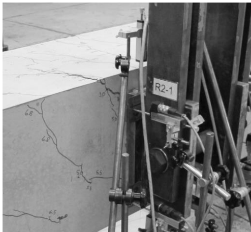
Bild 5-44: Rissbildung im Versuch R2-1 bei Höchstlast
