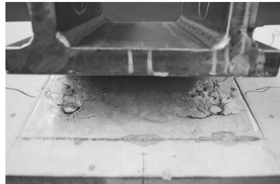
Bild 5-15: Stahlversagen der Kopfbolzen auf der lastabgewandten Seiten im Versuch R2-1
