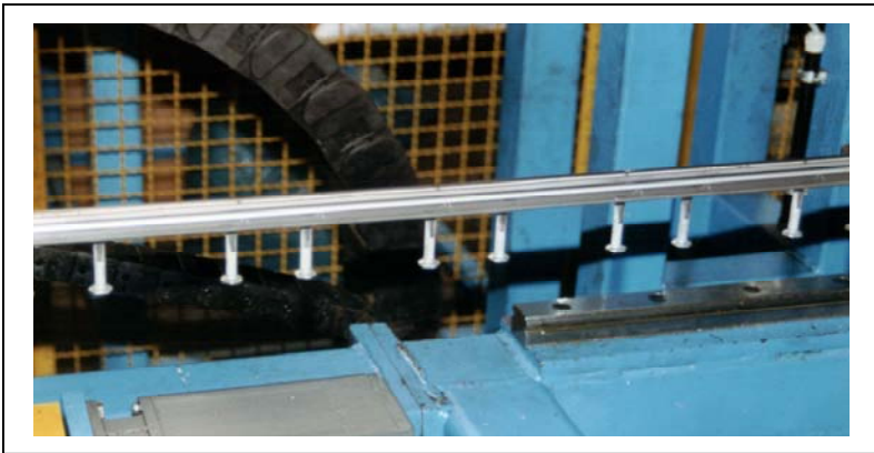
Bild 2.14 Herstellung von kaltgewalzten Kurzstücken (vor dem Zerschneiden)
