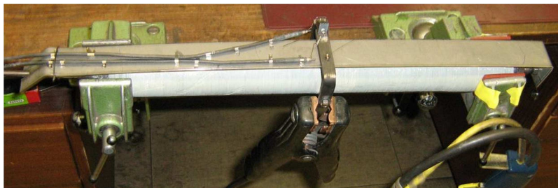
Bild 47: Instrumentierter kapazitiver Dehnungsmessstreifen auf Liner 7 an der MPA
