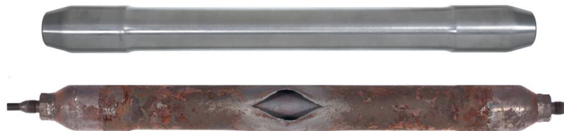
Bild 36: Liner 4 versagte nach 474 h unter dem Innendruck von 350 bar bei 600°C (beim Liner 9 nach 907 h)
