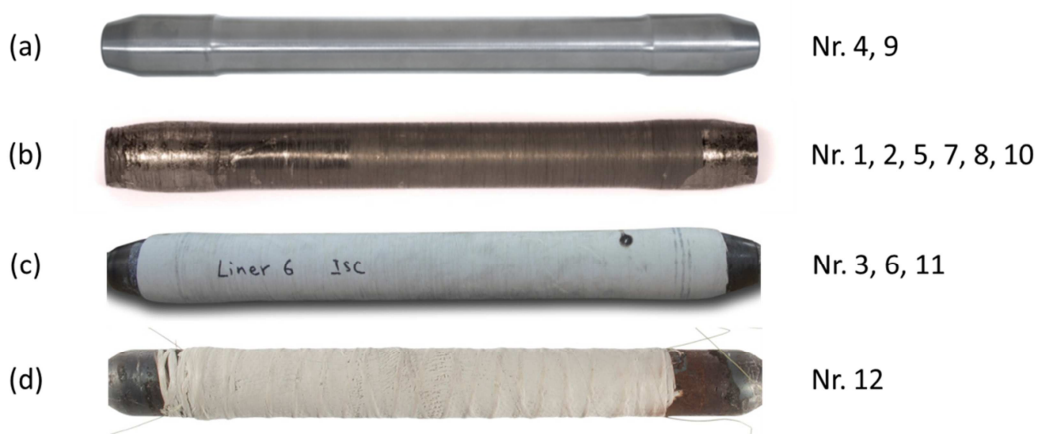
Bild 39: (a) Referenzrohr ohne Umwicklung; (b) Verbundrohr mit vom SKT gewickelter unidirektionaler Wicklung; (c) Verbundrohr mit vom ISC gewickelter unidirektionaler Wicklung; (d) Verbundrohr mit vom ISC gewickelter Gewebe-Wicklung
