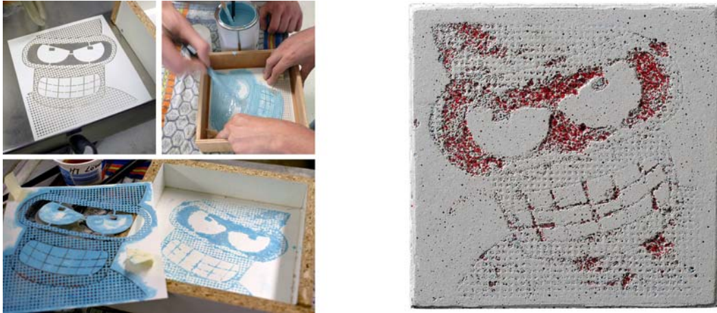
Abb. 5-15 Photobetonmotiv (Fahlbusch, Ruppert) gelaserte Schablone - Einbringung des Verzögerers – Endergebnis (Foto rechts: Miklautsch)
