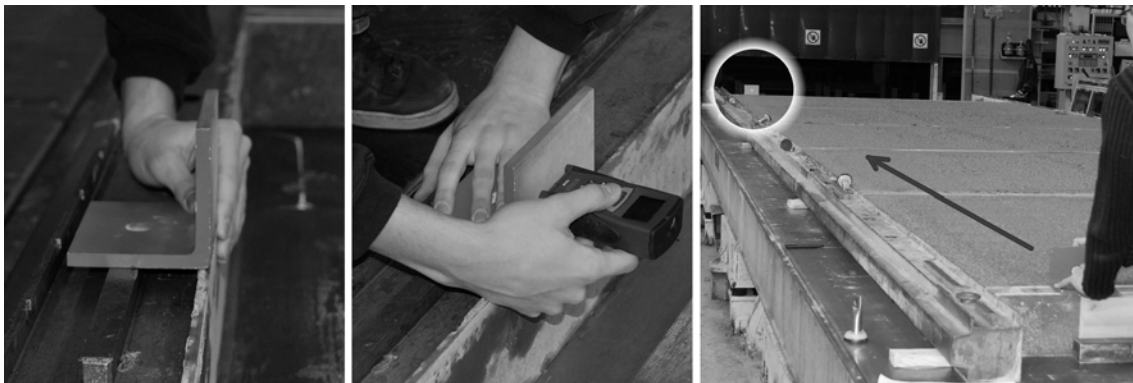
Abb. 6-5 Durchführung der Laserentfernungsmessung - Anlage von Winkel und Messgerät auf das Reflektionsziel
