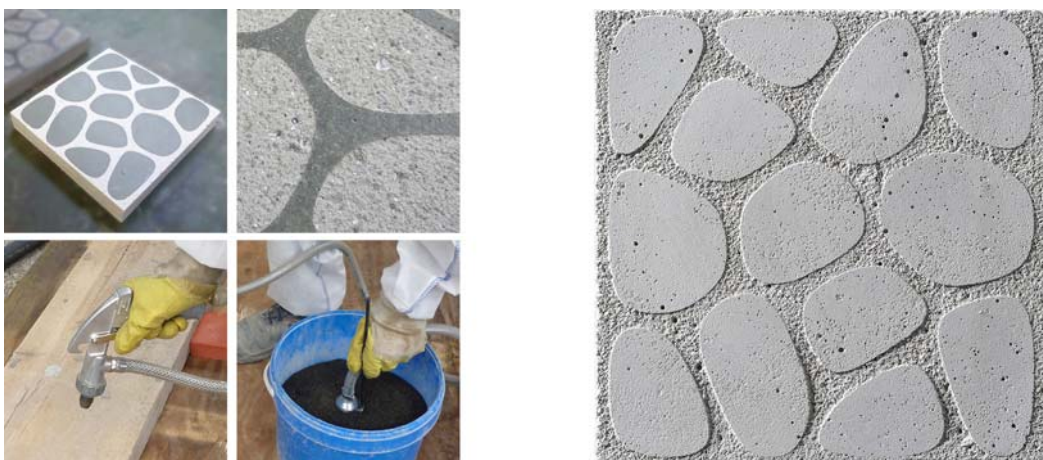
Abb. 5-16 sandgestrahlter Probekörper (Pelzer) – abgeklebter und gestrahlter Probekörper - Strahlpistole und Strahlmittelreservoir – Endergebnis (Foto rechts: Miklautsch)
