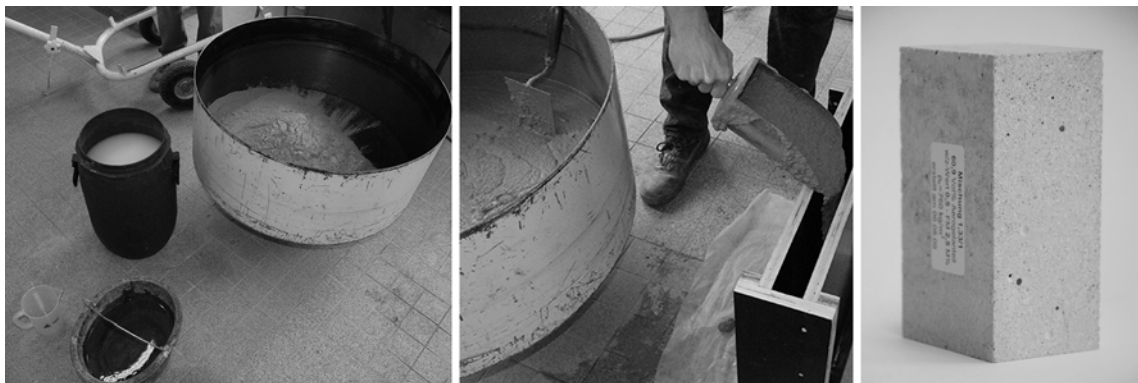
Abb. 5-11 Herstellung der Aerogelprobekörper im Betonlabor
