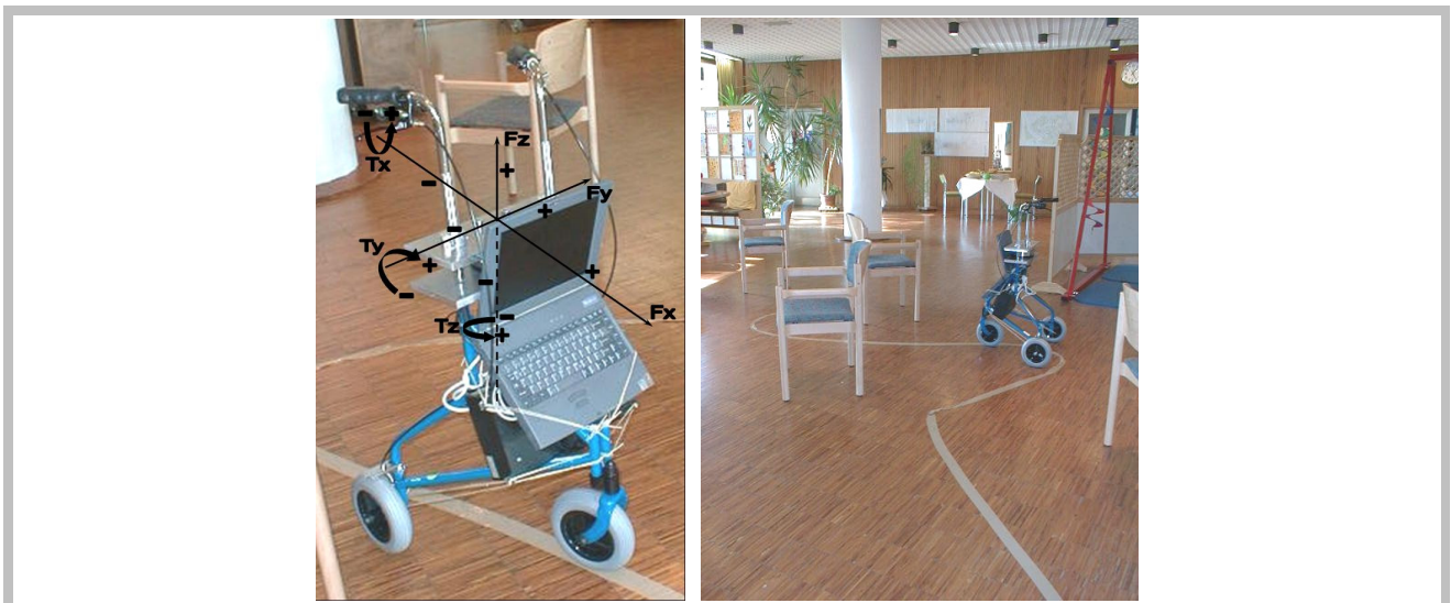
Bild 3-2: Versuchsaufbau und S-förmige Teststrecke.
