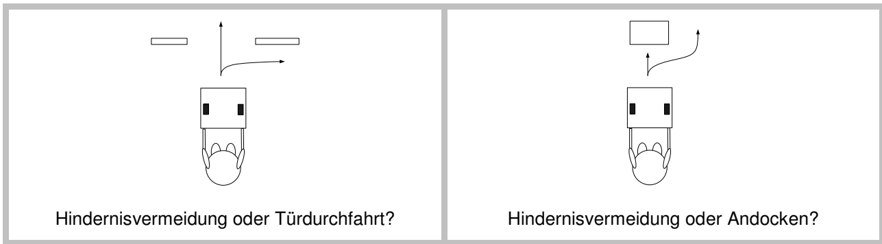
Bild 4-13: Typische Problemsituationen bei der teilautonomen Bewegungsführung.
