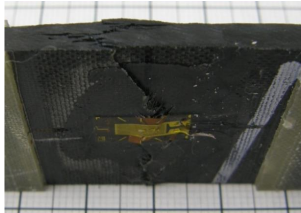
Abbildung 3.12: Bruchbild einer Druck- Probe T3090
