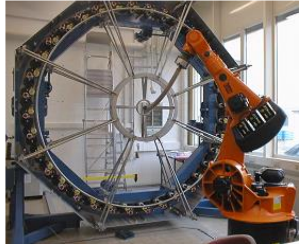
Abbildung 2.4: Horizontalflechter mit 144 Klöppeln und 72 Stehfadenzuführungen [5]
