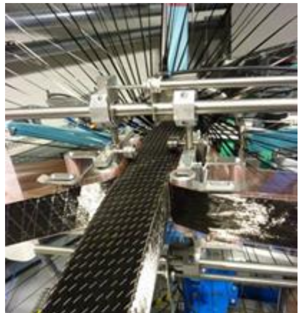
Abbildung 2.12: An der Flechtmaschine integrierte UD-Gelege-Zuführung [5]
