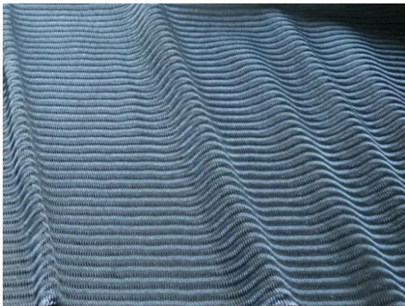
Abbildung 5.1: In der Ebene kompaktierte und vom Kern geschnittene, wellige Geflechtpreform
