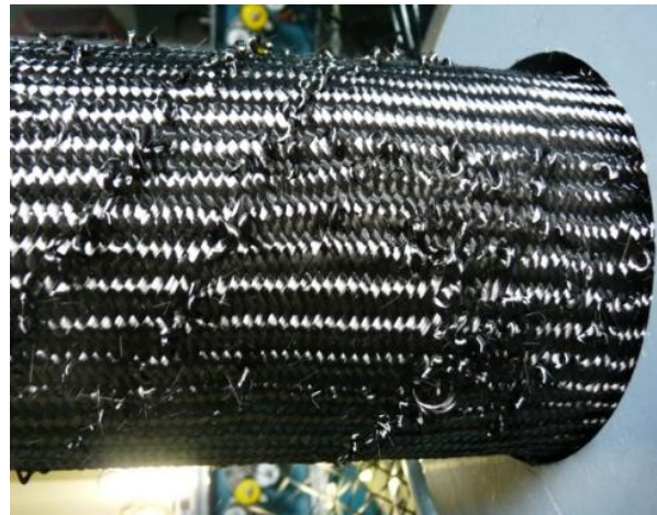
Abbildung 5.4: Schlaufen im Triaxialgeflecht
