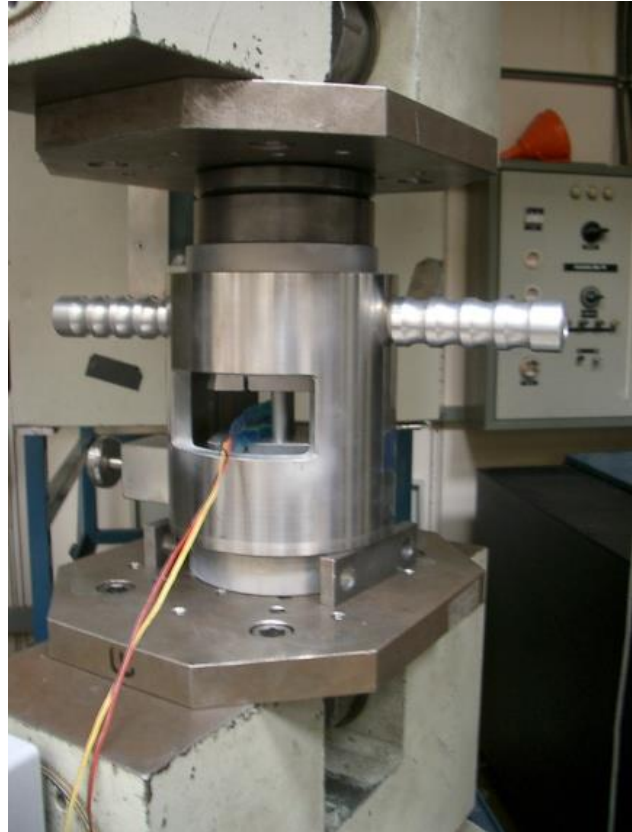
Abbildung 3.6: Prüfmaschinenkonfiguration für den Druckversuch (Celanese Druckvorrichtung) [110]
