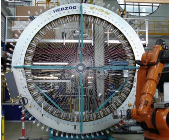
Abbildung 2.3: Radialflechter mit 176 Klöppeln und 88 Stehfadenzuführungen [4]
