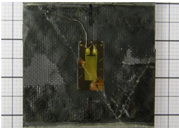
Abbildung 3.15: Bruchbild einer Druck- Probe B3000
