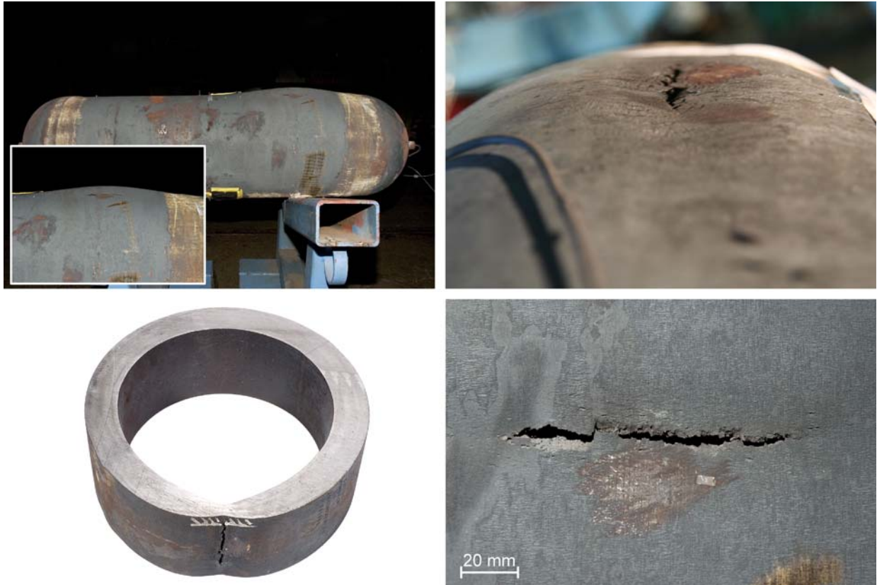
Bild 4.45: PK2 nach Versagen, starke plastische Verformung, Risslänge ca. 95 mm.
