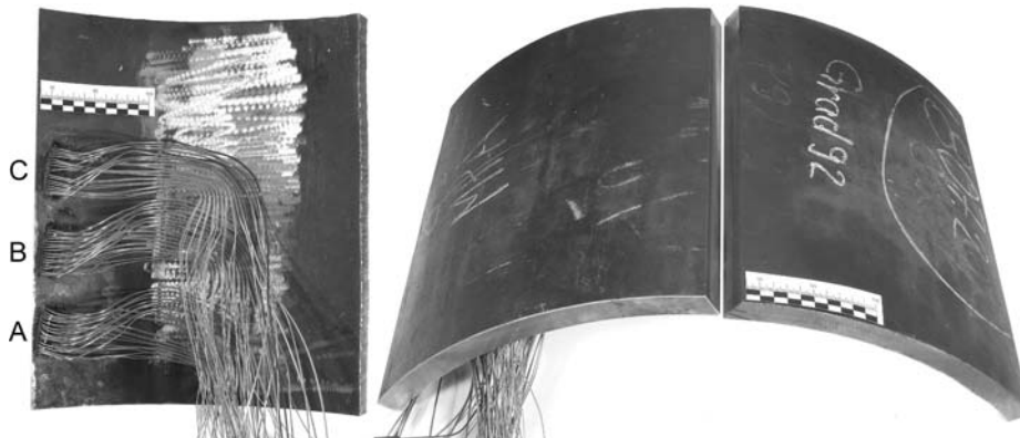
Bild 4.1: Instrumentierte Rohrsegmente für die Temperaturfeldmessung
