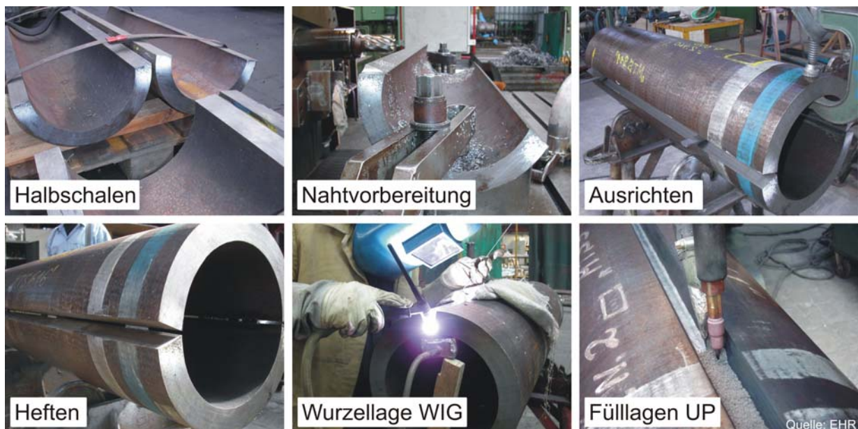
Bild 4.34: Fertigung der Prüfkörper bei der Firma EHR.
