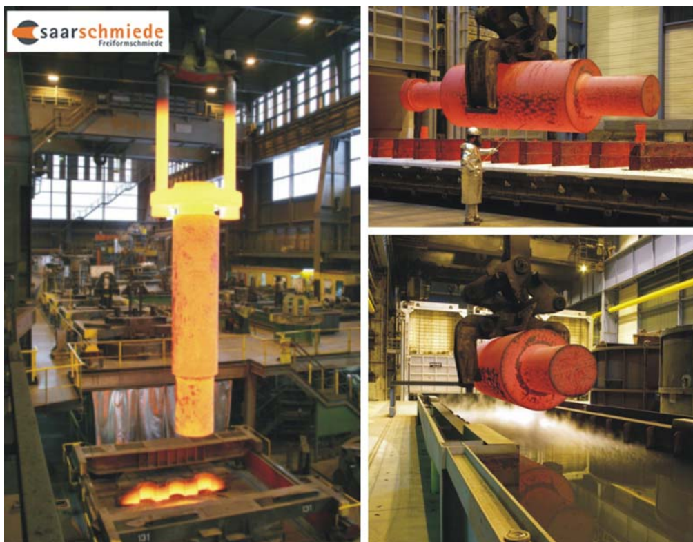
Bild 2.3: Wärmebehandlung geschmiedeter martensitischer Werkstoffe
