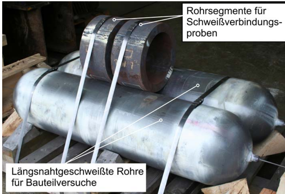
Bild 4.19 : Prüfkörper und Rohrsegmente im Anlieferungszustand
