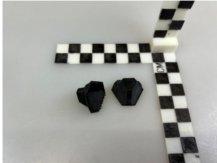
Abbildung 107: Grundkörper hergestellt mit dem freeformer . In Kooperation mit Arburg.
