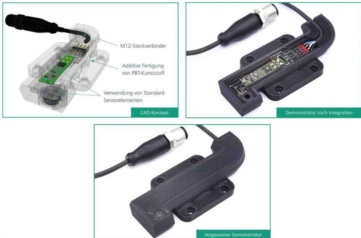
Abbildung 67: Individualisierter Sensor in den unterschiedlichen Fertigungsstufen: CAD-Konzept (oben links), nach der Integration der elektronischen Komponenten (oben rechts) und als fertiges Produkt (unten). Fraunhofer IPA (2022).
