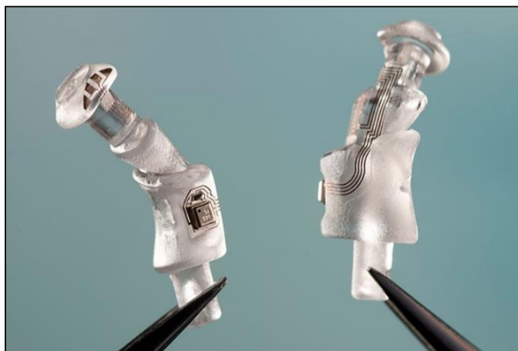
Abbildung 59: Otoplastik als iMST für eine permanente, nichtinvasive Blutdruckmessung im Ohr [199].
