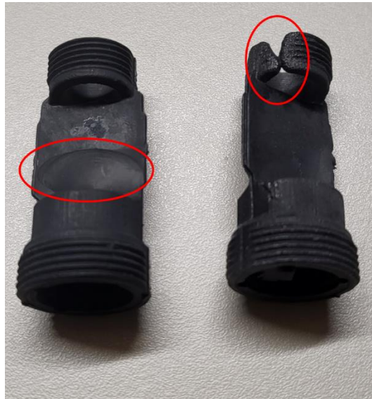
Abbildung 79: Fehlerhafte Bauteile vom Rapid-Tooling-Prozess.
