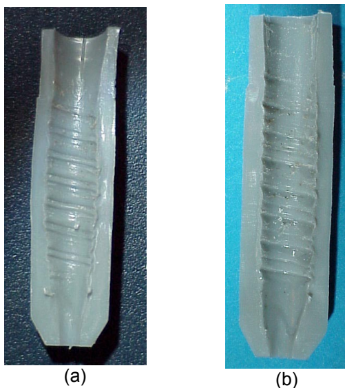
Bild 5.9 Fotos des eingedrückten Gewindes bei einem Nageldübel (a) direkt nach der Montage und (b) nach ca. 300 h.
